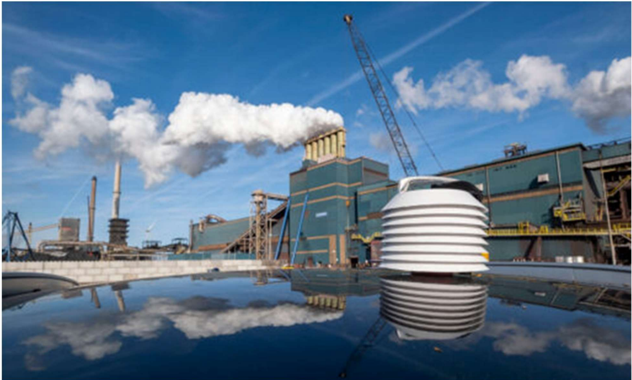
Figuur 7: De OD NZKG heeft ook beschikking over een mobiele eNose voor controles op en rond het Tata terrein
