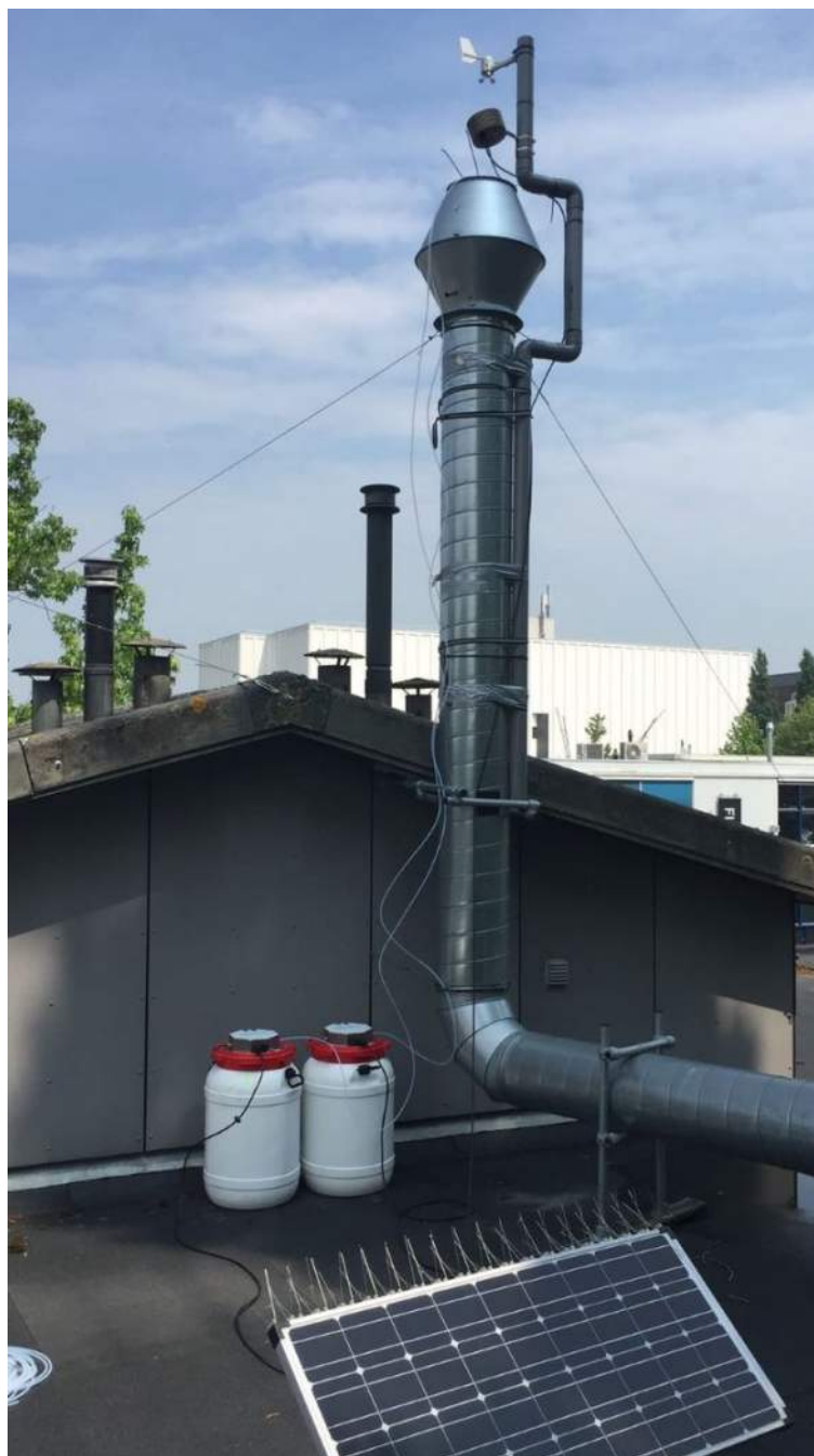
Figuur 9 Bemonsteren van een uitlaat voor olfactometrisch onderzoek
